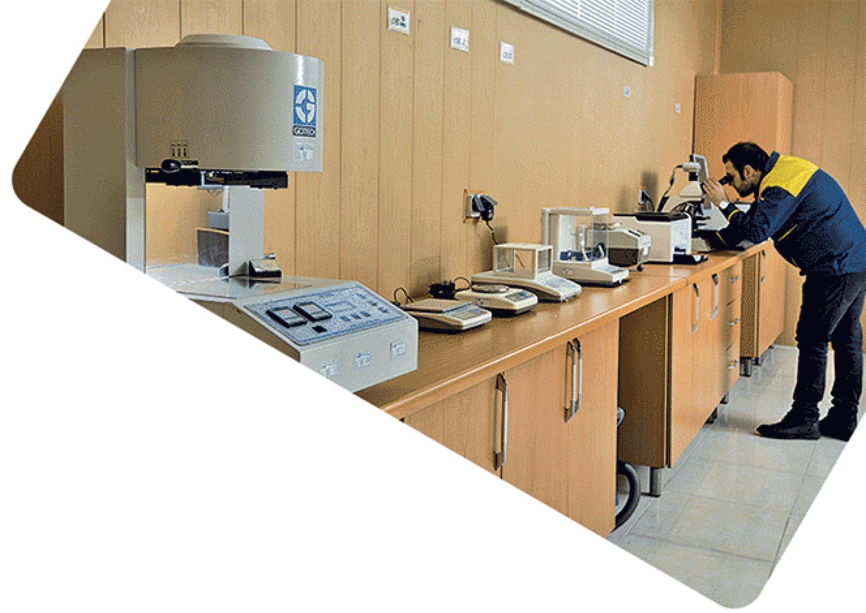
آزمایشگاه پلی اتیلن سمنان به عنوان آزمایشگاه همکار اداره استاندارد وظیفه کنترل کیفیت محصولات گروه صنعتی فناوری پلیمر ایران را به عهده دارد. این آزمایشگاه مجهز به دستگاههای مدرن شرکت IPT آلمان می باشد. کلیه تولیدات این مجموعه در قالب یک برنامه جامع کنترلی در سه بخش مورد بازرگانی و تست قرار می گیرند که شامل کنترل مواد اولیه ورودی به کارخانه، مرحله تولید و محصول نهایی می باشد.
